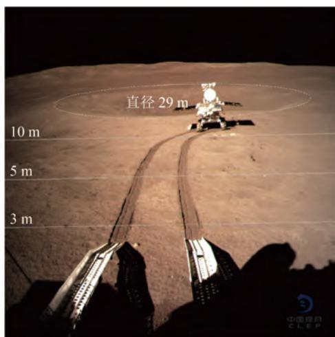
图2 监视相机单像量测结果(白线表示到着陆器前板的距离,撞击坑直径约为29 m)
